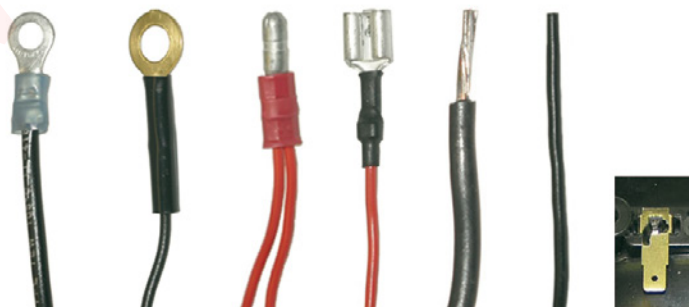
Alle nicht isolierten Anschlüsse, abgeschnittenen, freigelegten oder verzinnnten Enden
